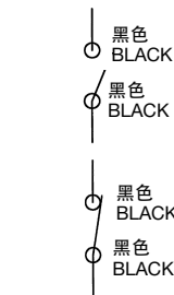
LEM6CANA 常开触点 NO CONTACT
