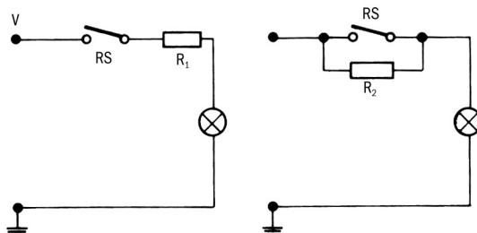
Fig. 5 Circuito con lámpara, resistencia en paralelo o en serie con el interruptor.
