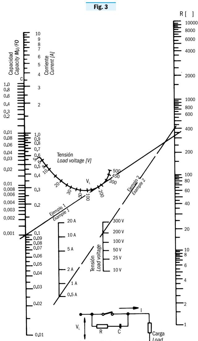
Filtro dimensionado con la conexión RC
