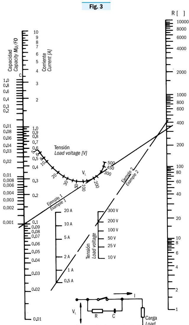
Filtro dimensionado con la conexión RC
