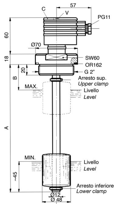
Le sonde di livello SL2FA...CVS1 e SL2TA...CVS1 con convertitore di segnale 4/20 mA alloggiato nel connettore C, sono state concepite per controllare in continuo il livello di un liquido contenuto in un serbatoio di stoccaggio.
