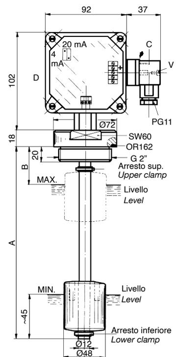
Le sonde di livello SL2FA...CVS2 e SL2TA...CVS2 con convertitore di segnale 4/20 mA alloggiato nella custodia D, sono state concepite per controllare in continuo il livello di un liquido contenuto in un serbatoio di stoccaggio.
