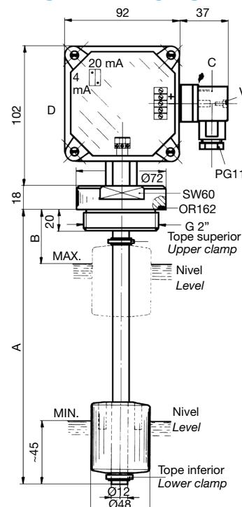
Los sensores de nivel SL1FA... CVS2, SL2FA... CVS2 y SL1TA... CVS2, SL2TA... CVS2 con convertidor de señal de 4/20 mA alojado en carcasa D, han sido concebidas para controlar continuamente el nivel de un líquido contenido en un tanque de almacenamiento.
