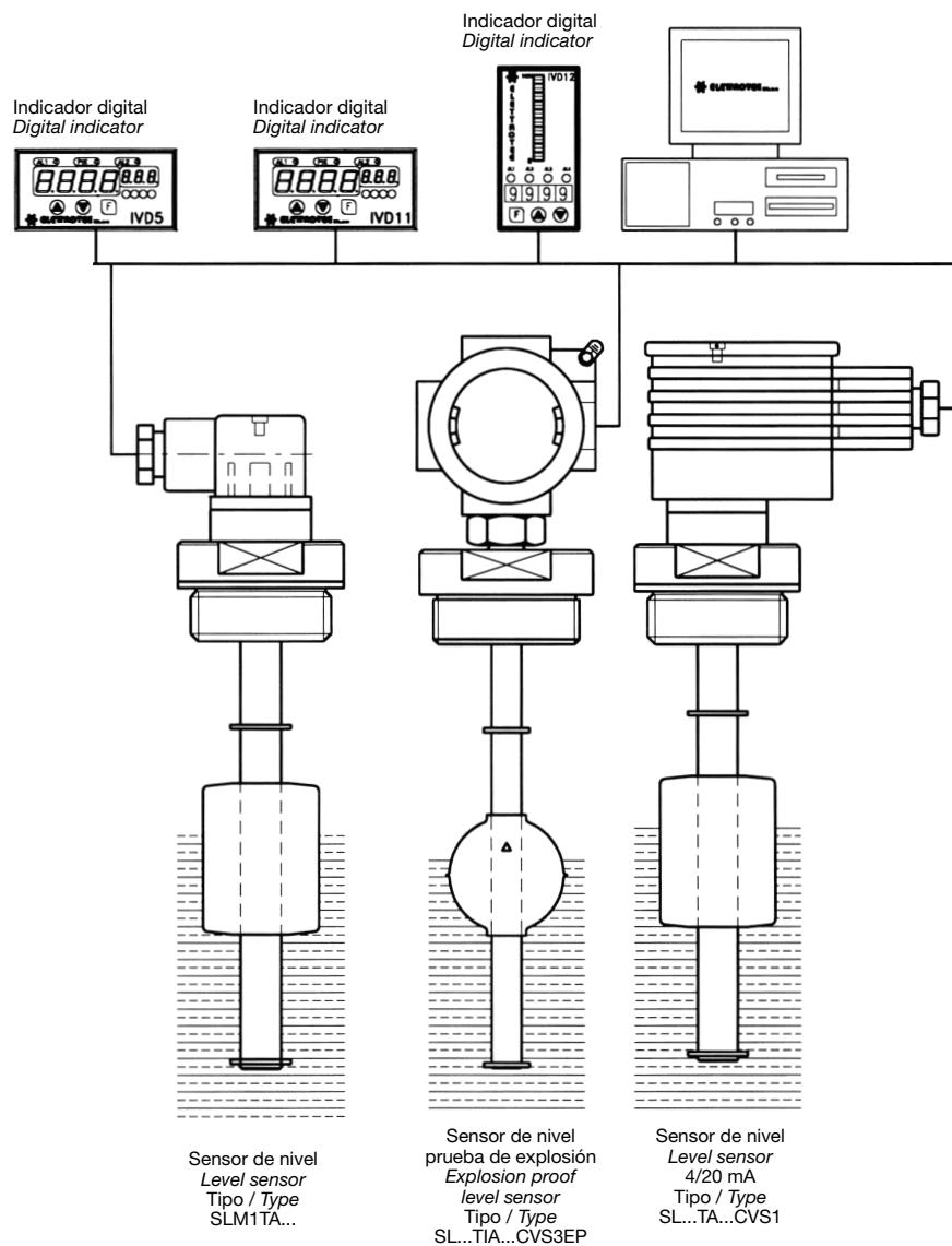
Los sensores de nivel Elettrotec están diseñados para controlar el nivel de un líquido. Se ha estudiado una serie de sondas de nivel flotante, completo con convertidor de señal "CVS", para que pueda proporcionar directamente en la salida una señal de 4-20 mA.
