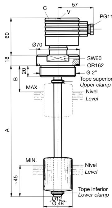
Los sensores de nivel SL1FA... CVS1, SL2FA... CVS1 y SL1TA... CVS1 SL2TA... CVS1 con convertidor de señal de 4/20 mA alojado en conector C, han sido concebidas para controlar continuamente el nivel un líquido contenido en un recipiente de almacenamiento.
