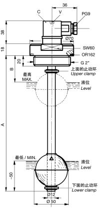
液位传感器SL1FIA...和SL2FIA...、SL1TIA...和SL2TIA...被设计成可 以通过我们的数字指示器在一定距离处连续地检查罐中液体的液位。
