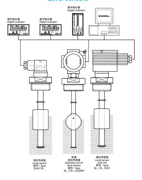
伊莱科最近设计了一系列新的浮子液位传感器。伊莱科液位传感器可以用腐蚀性介质的不锈钢制成,也可以用铝、黄铜管和腈基丁二烯橡胶浮子制成的法兰制造。设计了一系列浮子传感器可直接提供4/20 mA输出信号。这些传感器配有"CVS"信号转换器。它还设计了一个型号"SL...3...系列",该型号允许通过适当的微调器选择三个不同的可调警报设置点。
