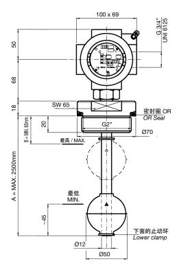
液位传感器SL1TIA...B...CVS3EP和SL2TIA...B...CVS3EP配备有 4/20 mA信号转换器,旨在连续检查罐中液体的液位。
